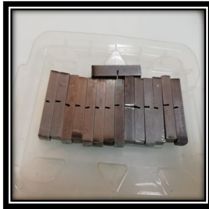
Fig.III.5. Un taille le milieu de la pièce en forme de U
