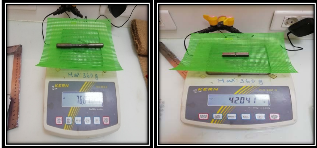
Fig.III.6. Mesurer l'échantillon par balance électronique modèle KERN
