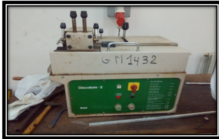
Fig.III.2. Découpage a disque modèle Discotom-2
