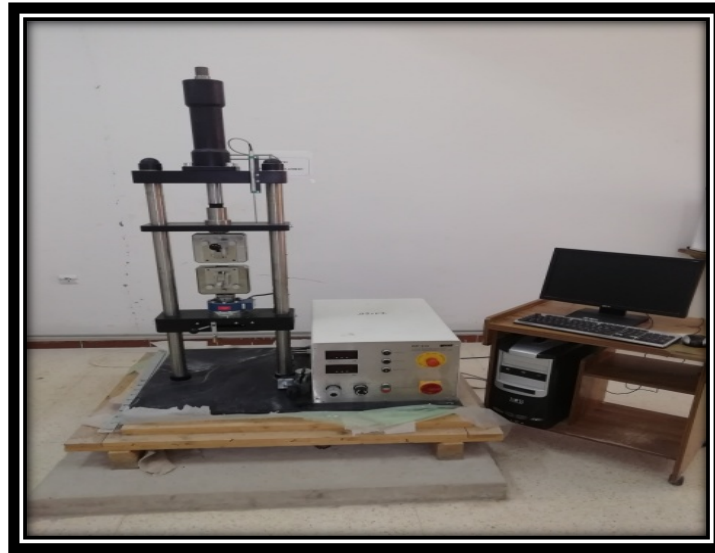
Fig.III.8. La machine d'essai de traction modèle WP 310
